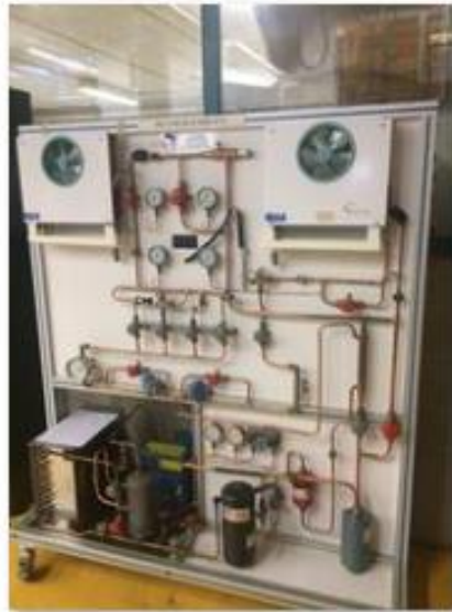
✔ banc de depannage frigorifique
