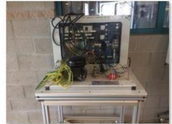
✔ banc etude des detendeurs frigorifiques
