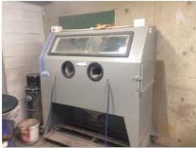
✔ Cabine de sablage
