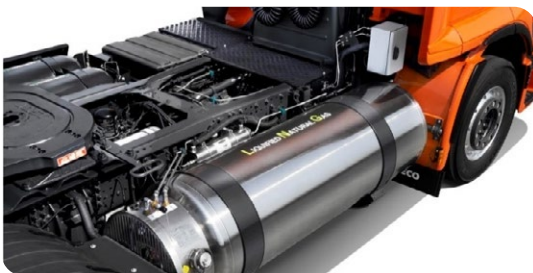
Fig. 4 - Réservoir LNG fixé au châssis
