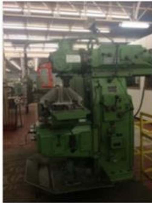
Fraiseuse conventionnelle pour plus grosses pièces
