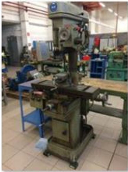
✔ Foreuse sur colonne
