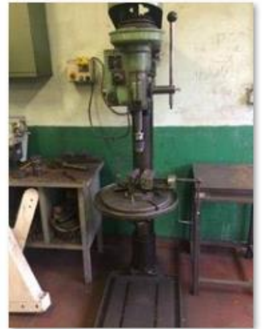
✔ foreuse sur colonne
