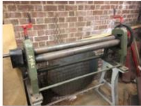
Planeuse manuelle à 3 rouleaux
