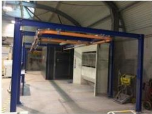
✔ 1. cabine peinture en poudre_four_convoyeur
