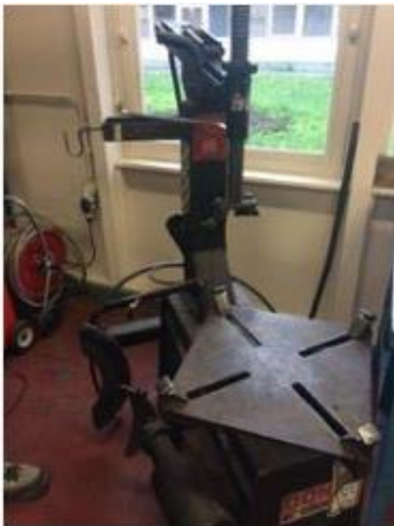
✓ Montage demontage pneus
